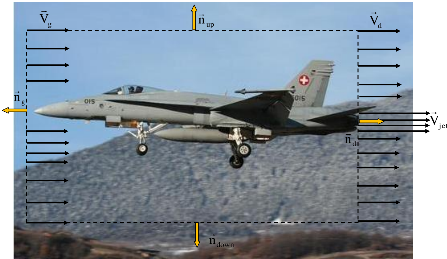
Figure 4 : Volume de contrôle attaché à l'avion
